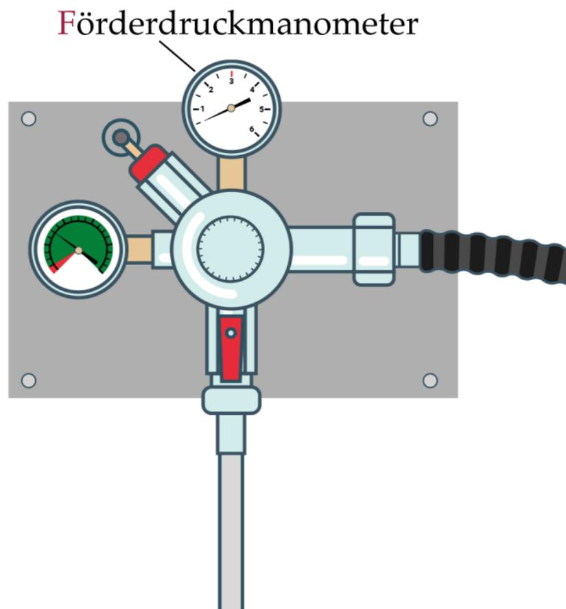
Ist der Druck zu niedrig eingestellt, drehen Sie bitte das Kohlendioxidventil so lange im Uhrzeigersinn, bis der Druck auf 2,0 bis 2,5 bar eingestellt ist.
