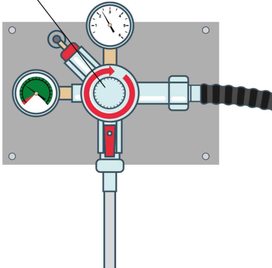
Falls vorhanden: Am Förderdruckmanometer am Zwischendruckregler erkennen Sie die Druckeinstellung.
