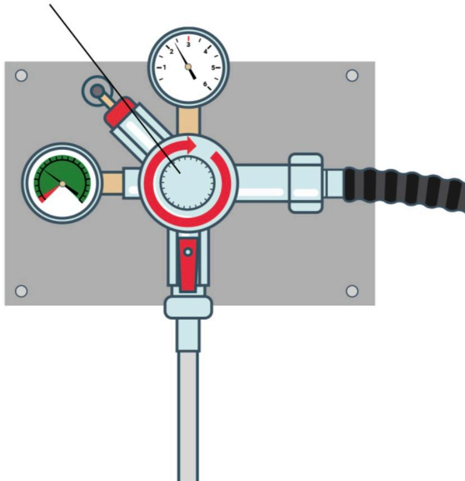
Falls vorhanden: Am Förderdruckmanometer am Zwischendruckregler erkennen Sie die Druckeinstellung.
